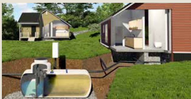
To-husanlegg (Dynamic 2) fra BIOVAC.
